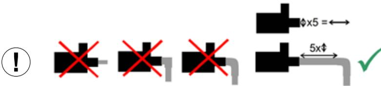
Wenn die Ansaugleitung länger als 10 Meter ist oder die Saughöhe größer als 1 Meter, muss der Durchmesser des Ansaugrohres größer sein als der Sauganschluss der Pumpe.
