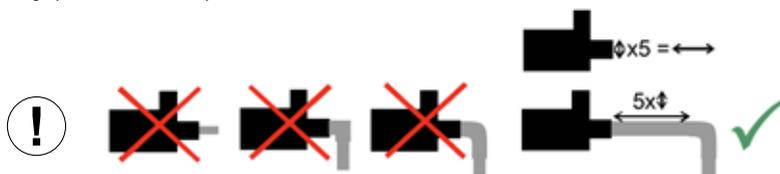
Als de zuigleiding langer is dan 10 meter of de zuighoogte groter dan 1 meter, moet de diameter van de zuigleiding groter zijn dan die van de zuigaansluiting van de pomp.
